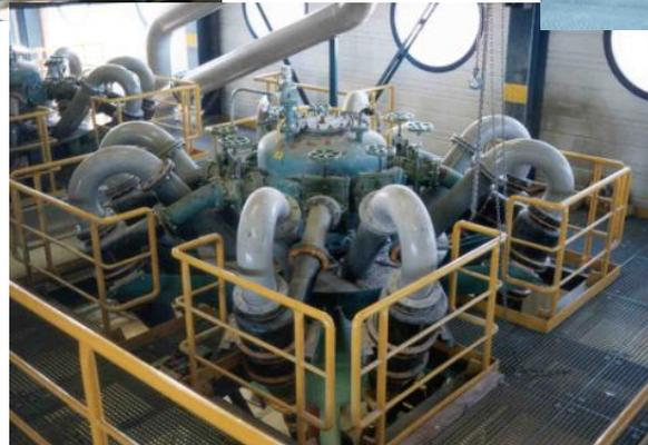
Hydrozyklone (63  $\mu\text{m}$ )
